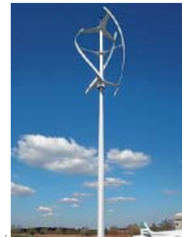
Éolienne à axe vertical Puissance: 40 kW Diamètre du rotor: 8 m Hauteur du mât: 16 à 24 m
