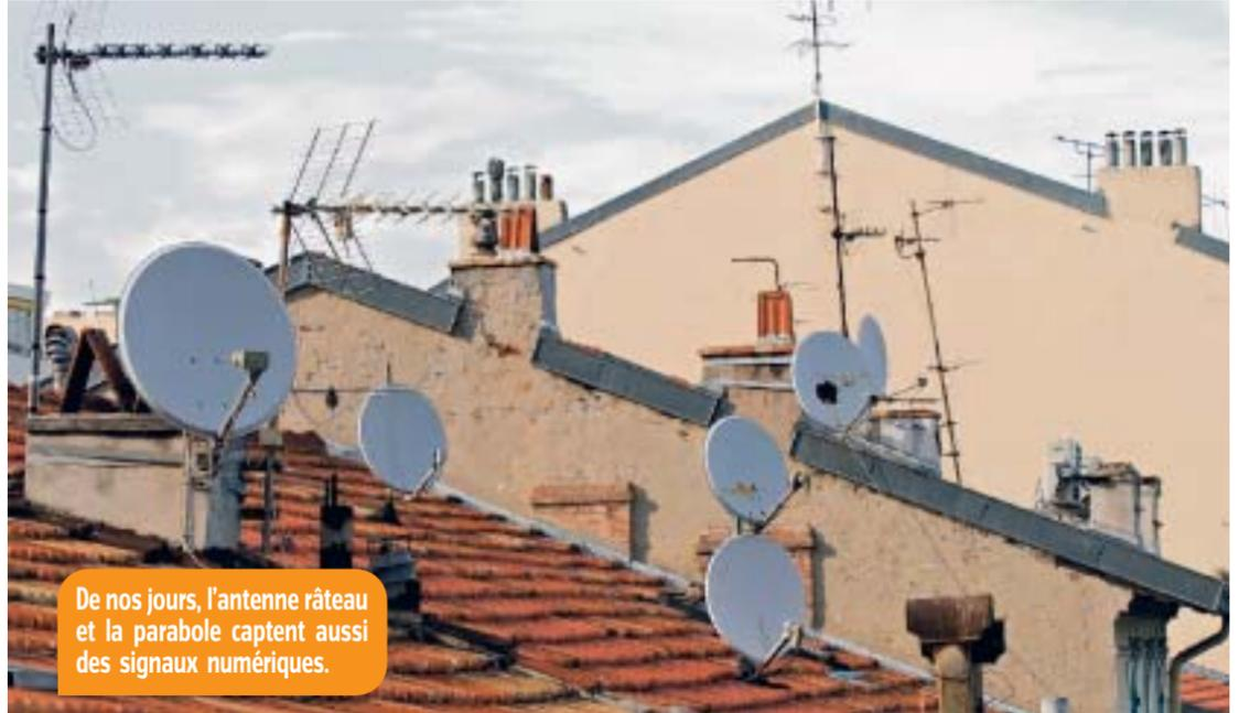
De nos jours, l'antenne râteau et la parabole captent aussi des signaux numériques.
